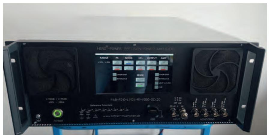
**Bild 6:** Der linear geregelte 4-Quadranten-Leistungsverstärker PAB-P210-LV124-R1-V030-DC420 wurde vom Hersteller für die Anforderungen im Automotive-Bereich ausgelegt.
