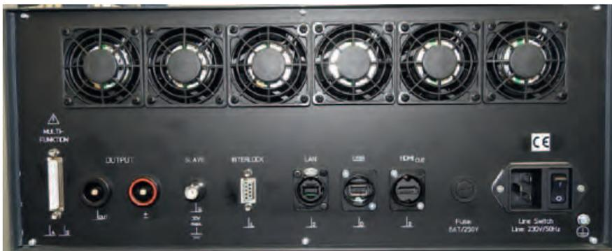
**Bild 5:** Rückseite des Leistungsverstärkers mit Netzeingang und Kommunikationsschnittstellen.
